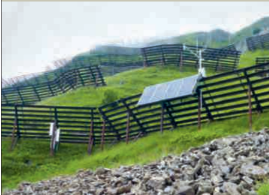
Abbildung 2: Versuchsanlage mit vier Solarmodulen in der Lawinerverbauung Chüenihorn in St. Antönien. Die Versuchsanlage misst die auf die Solarmodule wirkenden Kräfte und die Wetterparameter. Eine automatische Kamera dokumentiert das Einschneiverhalten. (Bild: S. Margreth; Projekt: energiebüro ag/Zürich/Schweiz – für Solarkraftwerke)
